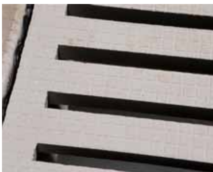
VIC Sterksel onderzocht de doorlaatbaarheid van een composiet rooster met spleten van 20 mm. FOTO: HANS PRINSEN
